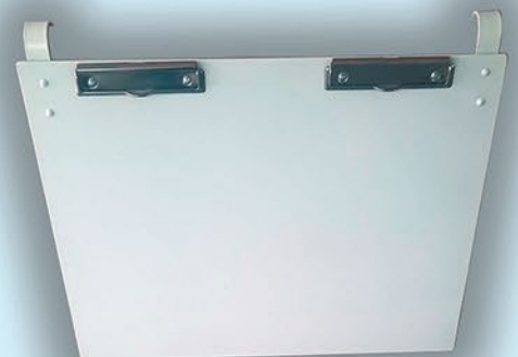
Naziv:Nosač temperaturne liste Za A3 format horizontalan dimenzije 440-450 mm x 350-370 mm Dve štipaljke za držanje temperaturne liste Materijal: Aluminijumski lim 2 mm Zaštita: Plastifikacija. (Na zahtev antibakterijski prah) Površina otporna na sredstva za čišćenje i dezinfekciju koja se koriste u medicini.
